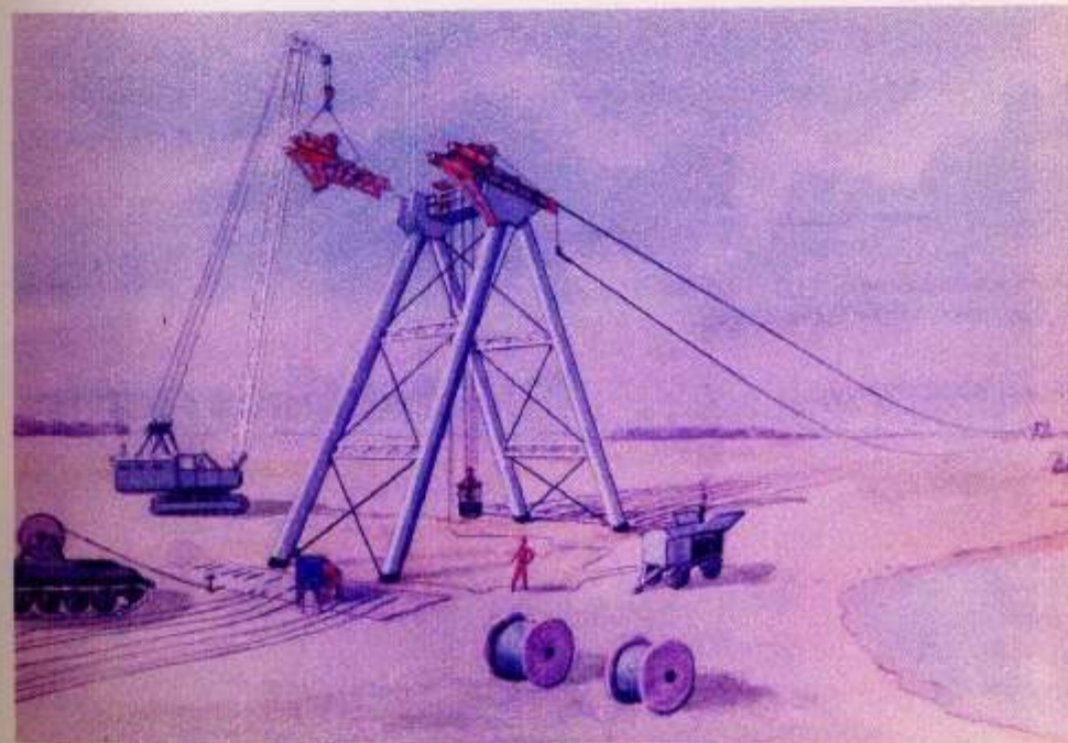
Рис. 2.26. Натяжение струны на анкерную опору
