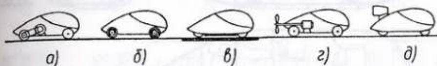
Рис. 2.17. Транспортный модуль с различными типами приводного агрегата: а, г — двигатель вращения с приводом на колесо и воздушный винт, соответственно; б — мотор-колесо; в — линейный электродвигатель; д — газовая турбина
